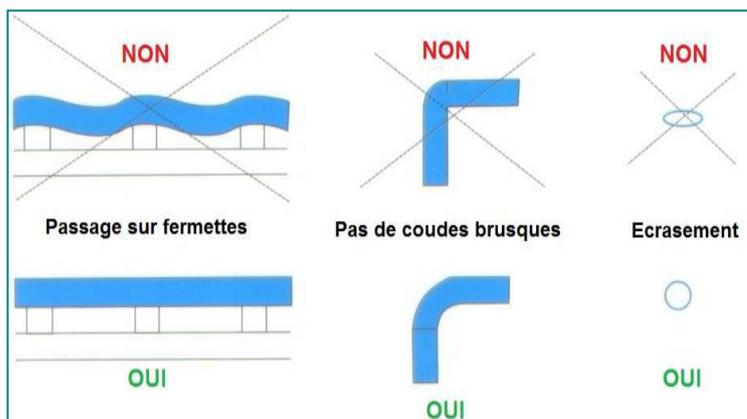
4 : Schéma de bonnes et de mauvaises mise en œuvre des conduits souples (passage sur fermette, coudes et écrasement)
